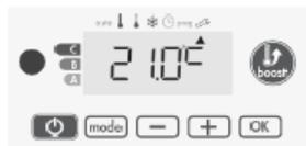
Aumentare di 2°C la temperatura rilevata dal sensore di temperatura ambiente premendo [+].
