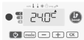
Diminuire di 2°C la temperatura rilevata dal sensore di temperatura ambiente premendo [-].
